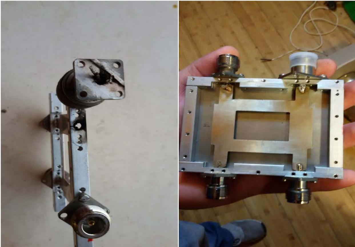
Sostituito velocemente il connettore di uscita e ripristinato l'anello ibrido il doppio amplificatore è ripartito regolarmente ritornando ad erogare tutta la potenza come in origine di 360W .
